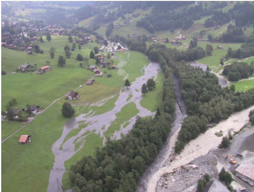
Abb 43 Mit Geschiebe überlasteter Zusammenflussbereich Schwarze und Weisse Lütschine in Grindelwald
